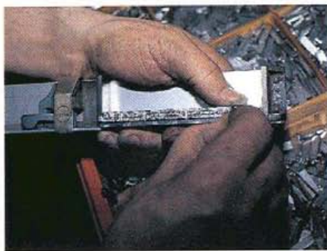
Quelques hiéroglyphes parmi les 4 140 gravés sur trois corps en 1842 - 1852 Composteur à curseur permettant de justifier les lignes Composeuse linotype à tringles © E. de Chazournes
