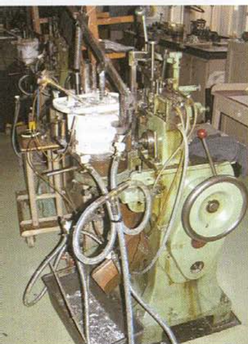
Fondeuse «kü-co» pour la fabrication de caractères «lettre à lettre» © E. de Chazournes
