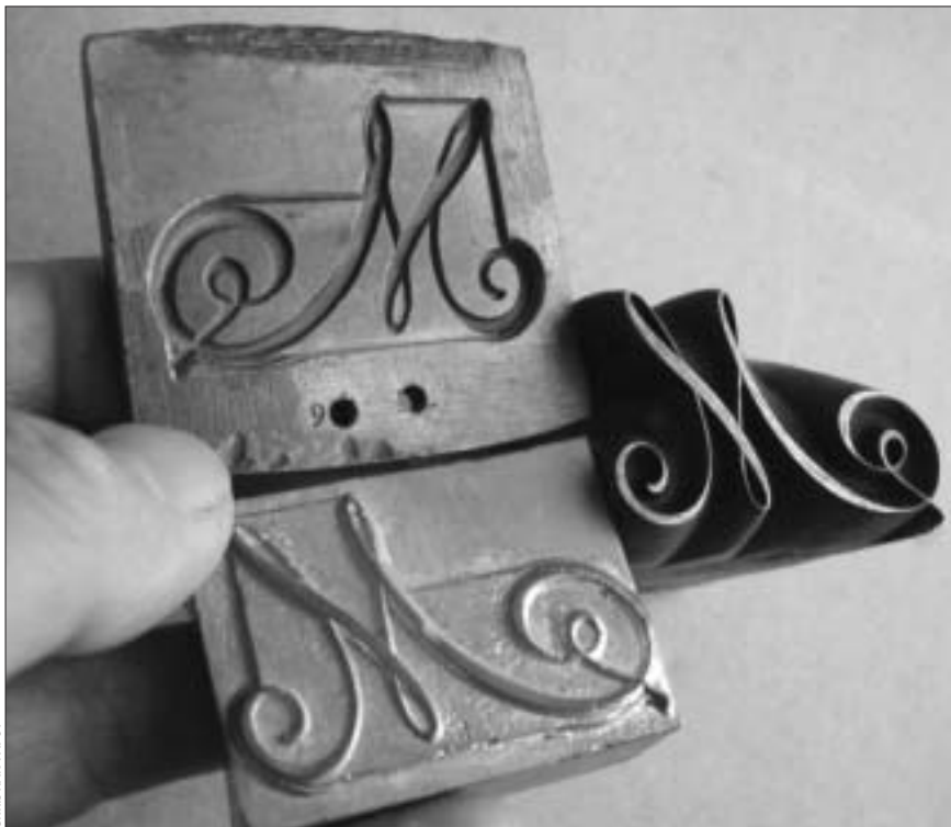
Figure 2. À droite, poinçon d'un M cursif, en haut la matrice après frappe et, en bas, le caractère moulé dans cette matrice. Les doigts donnent l'échelle (il s'agit donc d'un M de très gros corps)
